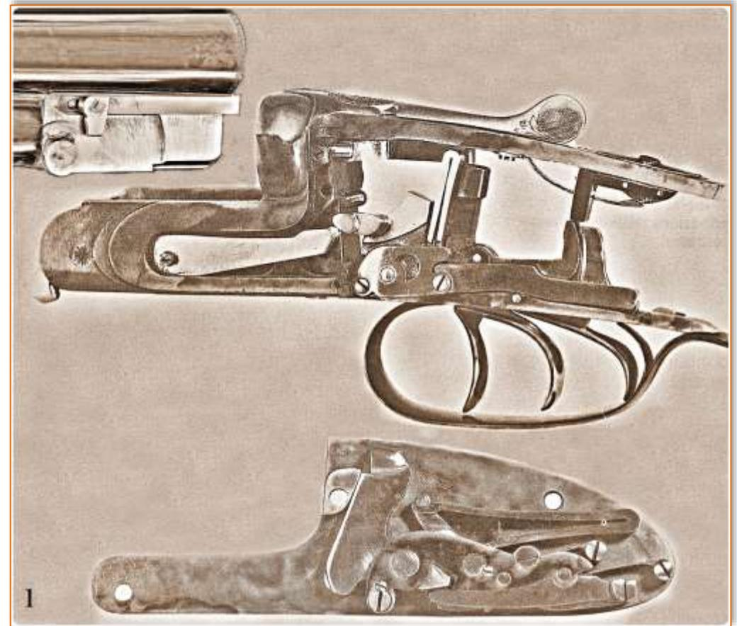
Fig.1- Una delle prime triplette di Salvatore Cortesi. Progettata alla vigilia della seconda guerra mondiale e costruita nel '50ca. Calibro 20, acciarini laterali con molla indietro e batteria sul ponticello per la canna inferiore. La leva sinistra arma sia l'acciarino sx che la batteria.
