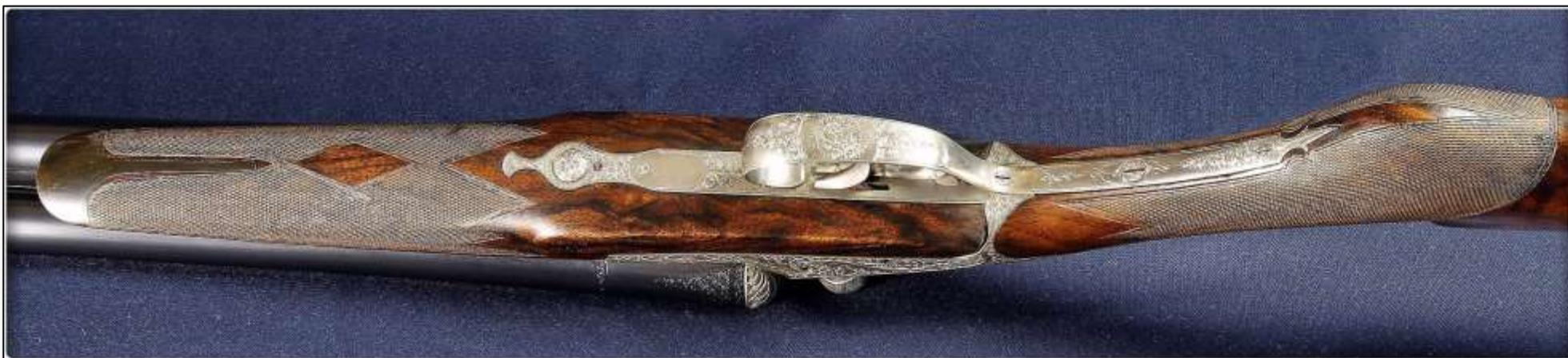
Fig.1)- Le canne sono fissate ad incastro alla tavola della bascula.
