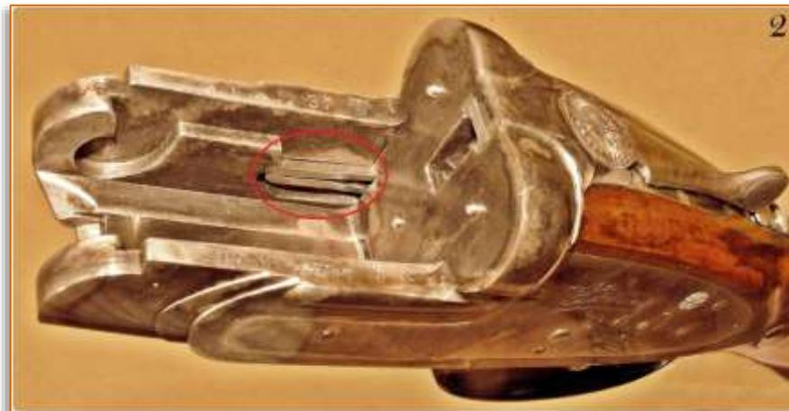
Fig.2- Tripletta di Salvatore, costruita nel 1992. Per mantenerla proporzionata al calibro 20, le molle avanti degli acciarini entrano nella bascula, sul cui fondo scorre la slitta che arma i tre cani.
